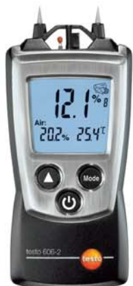
testo 606 水分計 新增環境溫溼度功能 內建多種材質設定
